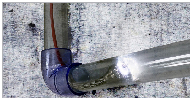
30 m 高彈性探測管、可輕鬆通過 90 度彎角
