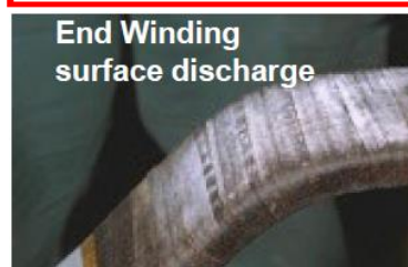
线圈端部表面放电
